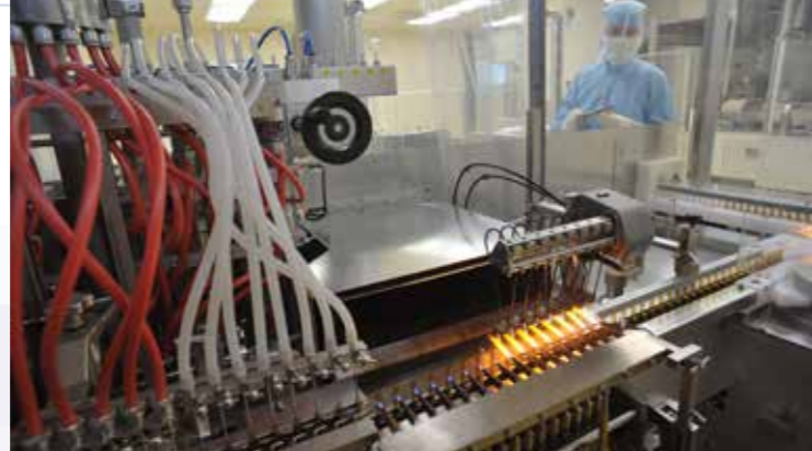
Ampullenfertigung von bis zu 25.000 Einheiten pro Stunde bei EVER Pharma Jena GmbH
